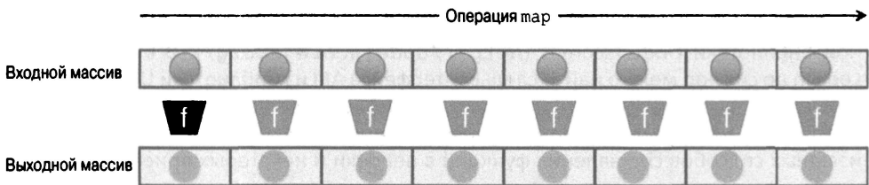
Рис. 3.4. В операции map функция-итератор f применяется к каждому элементу исходного массива и возвращается новый массив равной длины
