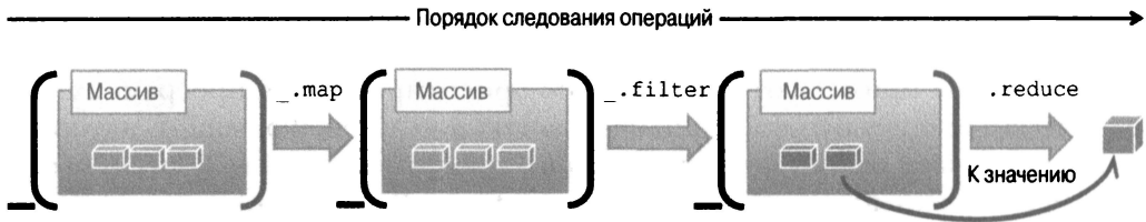
Рис. 4.3. Цепочка массивов, состоящая из методов, последовательно вызываемых через владеющий ими объект. Внутри ее каждый метод возвращает новый массив, содержащий результат вызова каждой функции
