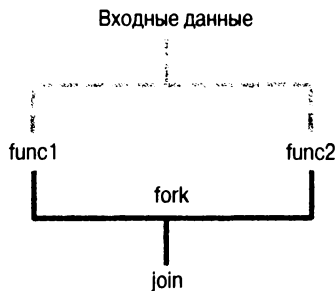
Рис. 4.14. Комбинатору fork() передается три функции: одна — join() и две — func1 и func2 типа fork . В частности, функции типа fork выполняются относительно предоставляемых входных данных, а конечный результат объединяется в функции типа join
