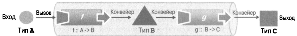
Рис. 4.4. Конвейер функций, начинающийся с функции f , которой передаются входные данные типа A и которая формирует объект типа B , который затем передается функции g , выводящей объект типа C как конечный результат. Функции f и g могут относиться к любой библиотеке или быть вашими собственными функциями
