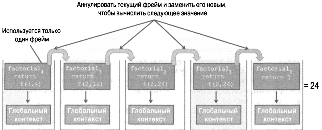
Рис. 7.9. Иллюстрация вызовов хвостово-рекурсивной функции factorial(4) . Как видите, в этой функции используется единственный фрейм. Оптимизация хвостовых вызовов заключается в аннулировании фрейма текущей функции в стеке и распределении на его месте нового фрейма, как будто бы функция factorial() вычисляется в цикле
