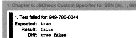
Рис. 6.9. Непрохождение теста обнаруживается в результате неверной проверки свойств средствами QUnit. Если выполнить рандомизацию входных данных, чтобы включить в них недостоверные данные, то алгоритм JSCheck обладает достаточной энтропией, чтобы 89 тестов из 90 не прошли
